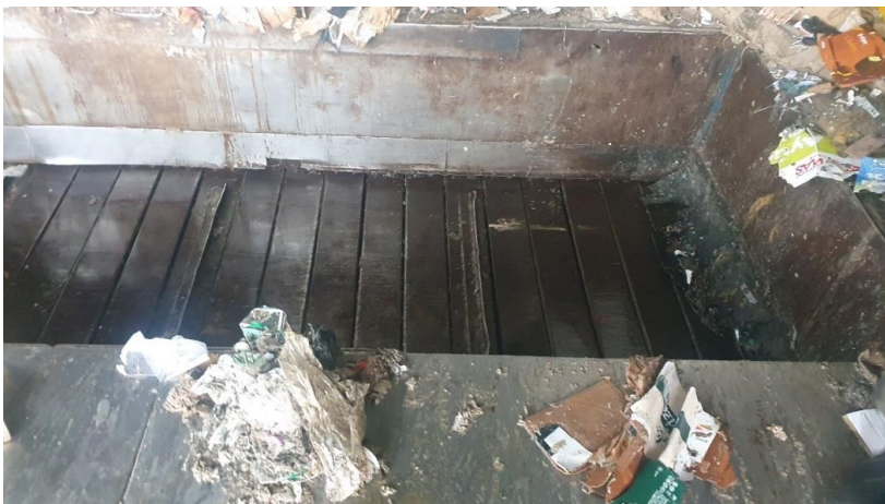
Vista de las instalaciones de la nave de Tratamiento II. Detalle de la cinta de la clasificadora a dismantelar.
